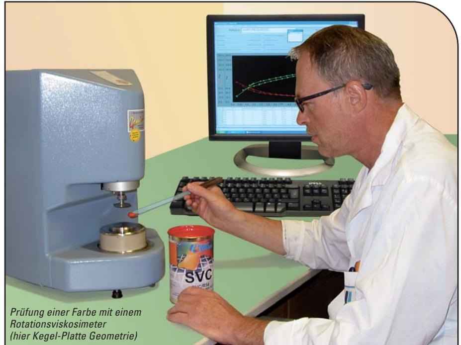
Prüfung einer Farbe mit einem Rotationsviskosimeter (hier Kegel-Platte Geometrie)
